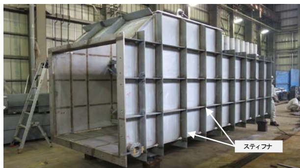
図-11 減勢工保護板の外観
