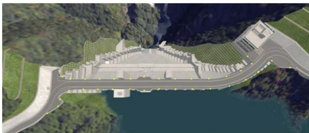
図-19 照明配置案（約15mピッチ）
