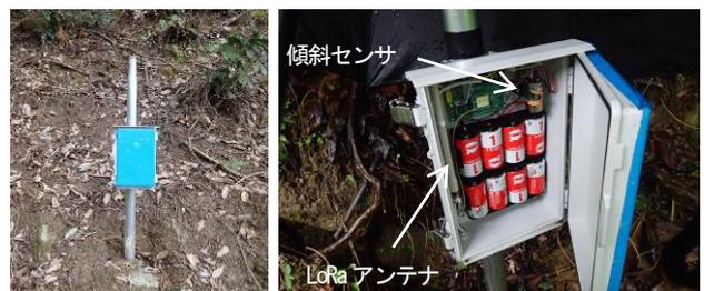
写真-1 地表傾斜計の設置状況と傾斜計の内部状況
