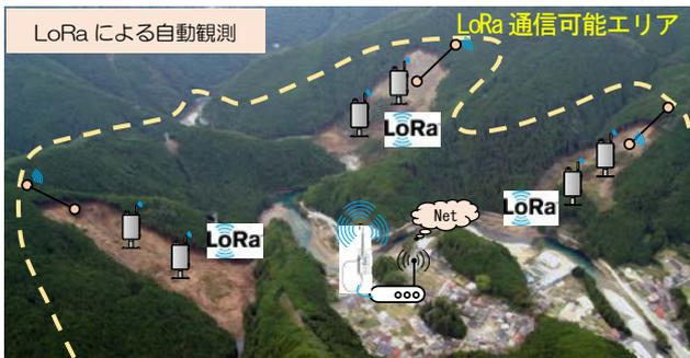
図-4 従来の自動観測システムとLoRaの通信技術による観測のイメージ
