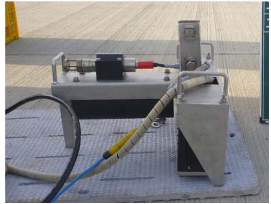
写真-2 ナローマルチビーム音響測深機
