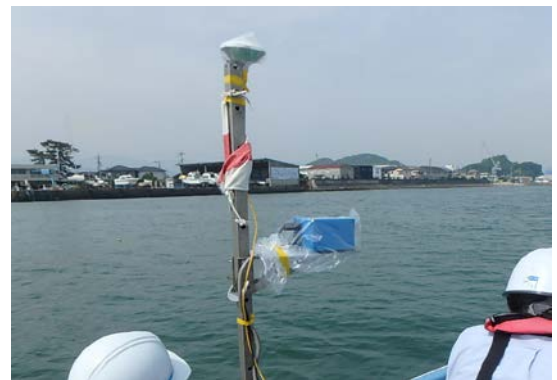
写真-3 GNSS(上)と動揺方位センサー(下)
