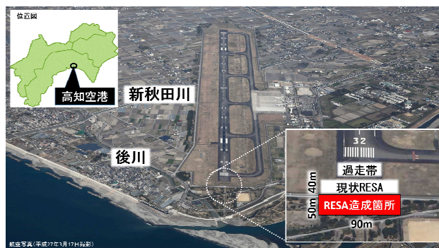
図-2 位置図及びRESA造成箇所
