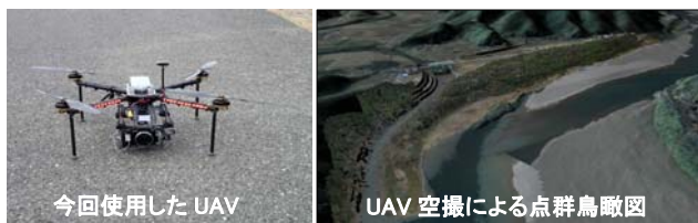
図-6 UAV と空撮による既存河畔林の点群鳥瞰図
