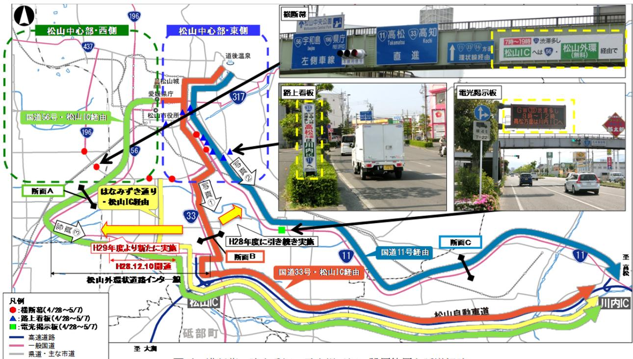
図-4 横断幕・路上看板・電光掲示板の設置位置と誘導経路
