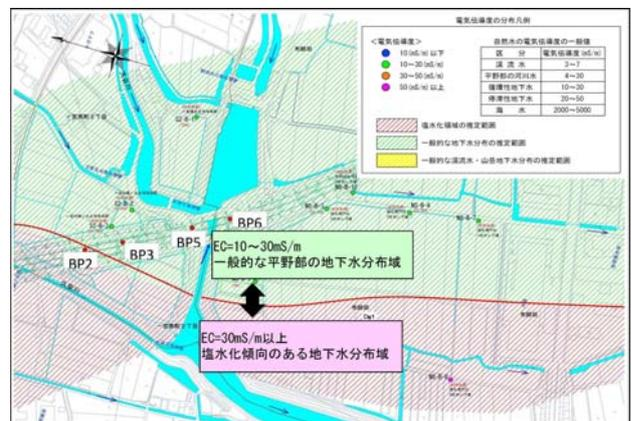
図-6 電気伝導度分布図
