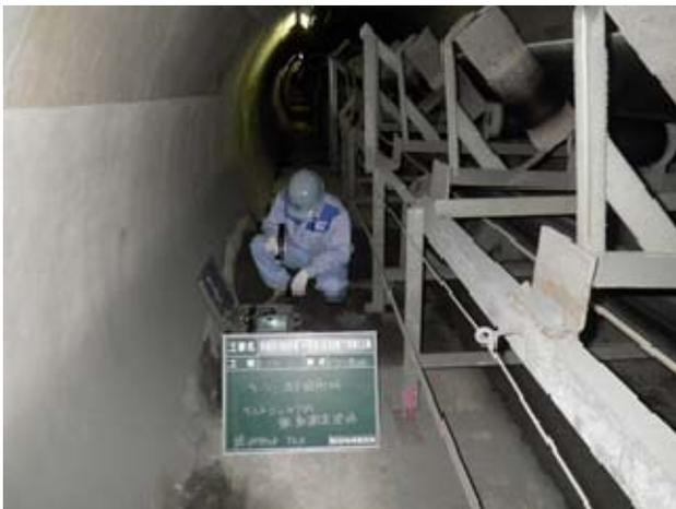
図-10 地下トンネル内振動観測状況
