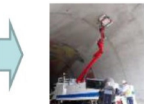
レーザー打音による変状の把握
