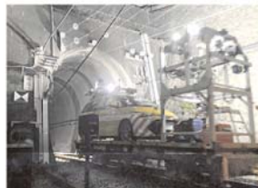
鉄道トンネルにおける道路用 3次元点群データ計測車両の活用
