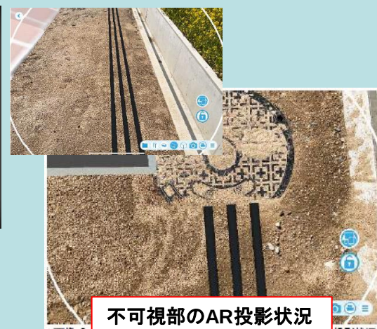
LiDARを用いた光ケーブル配管工の出来形計測結果
