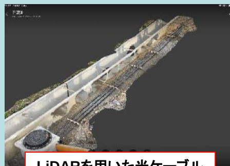
LiDARを用いた光ケーブル配管工の出来形計測結果
