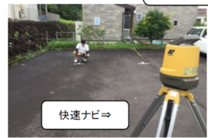
快速ナビによる水準測量・観測データの取得
