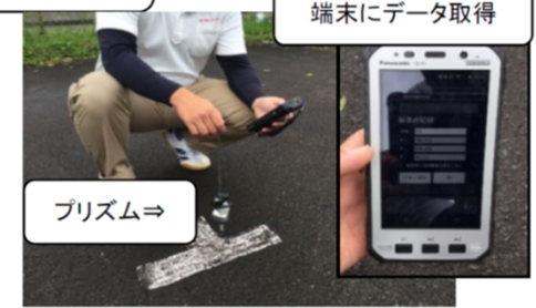
快速ナビによる水準測量・観測データの取得
