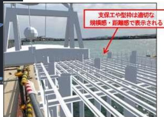
徳島小松島港金磯地区岸壁(-11m)改良におけるCIMモデル
