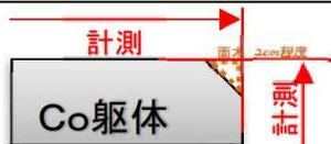
面取り部分は補助線から算出します。
