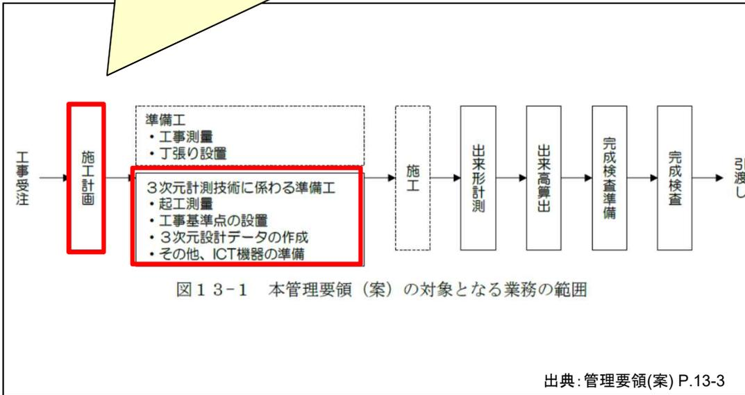
3次元計測技術を用いた出来形管理では、施工計画書に適用工種、使用機器等の事項を記載する必要があります。
