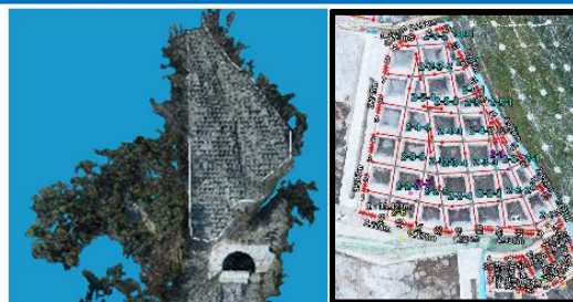
3次元データによる法枠の出来高算出
