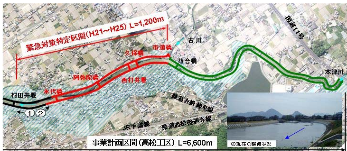
: H20までに施工済 : 緊特施工箇所 : 未施工箇所 : H16台風23号浸水域
