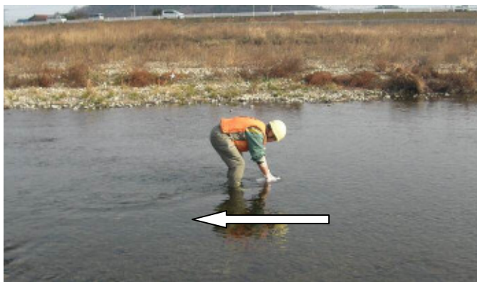
図-3.2 試料容器による直接採水
