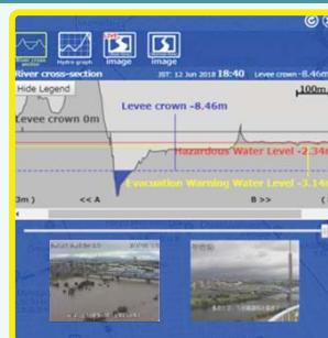
【河川横断面図】 川の水位とまち側の地盤の高低差を断面図で表示
