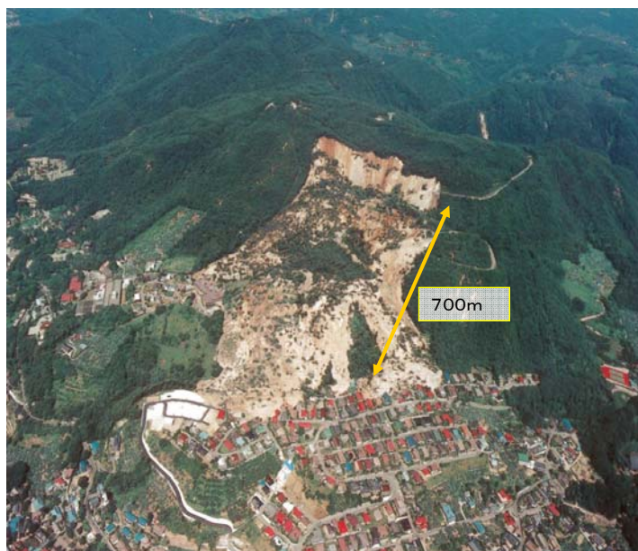
幅約450m、長さ約700m、移動土量約500万m 3 、 死者26名
