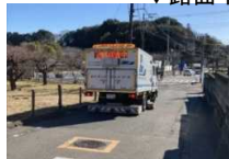
(空洞探査車による調査)
