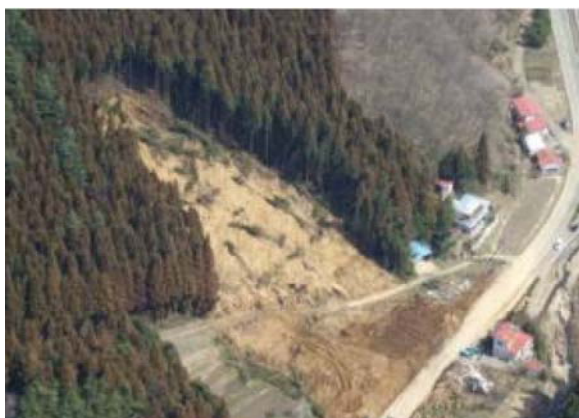
図 3-8 東日本大震災 自然法面崩壊被害状況写真
