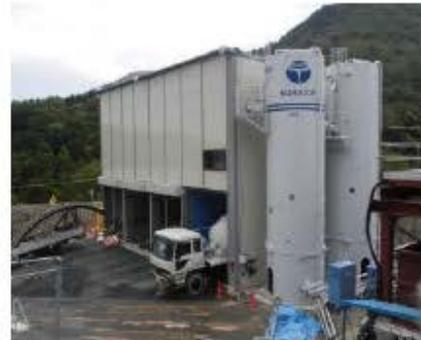
セメントと骨材をストックし、吹付け用の生コンクリートを製造する設備です。昼夜施工する吹付け作業に生コンクリートを供給できるように設置します。
