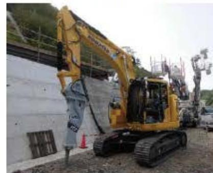
先端のピルで打撃を与えて岩盤を破碎します。発破後の地山の仕上げ掘削に使用します。
