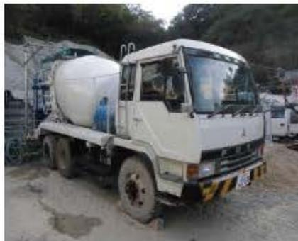
掘削後のトンネルが崩れるのを防ぐために、吹付けプラントで製造したコンクリートを吹付け機に運びます。
