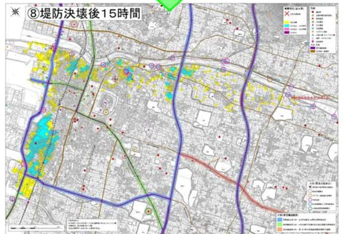
浸水深時系列変化図（テーブルNo.10）堤防決壊地点：左岸8.4k
