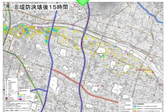
浸水深時系列変化図（テーブルNo.11）堤防決壊地点：右岸5.8k
