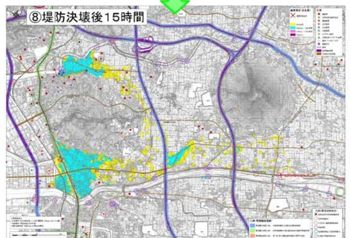
浸水深時系列変化図（テーブルNo.12）堤防決壊地点：右岸9.6k
