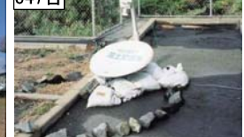
小型画像伝送装置 Ku-sat
