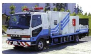
排水ポンプ車(排水能力毎分30m³の水中モータ式)
