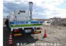
排水ポンプ車(中国地方・広島県)
