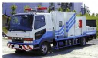
排水ポンプ車(排水能力毎分30m³の水中型モータ式)
