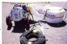
排水能力毎分6m 3 の排水ポンプを5台搭載。
