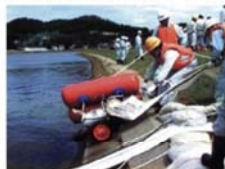
ポンプは人力で水中に投入できるように軽量化。
