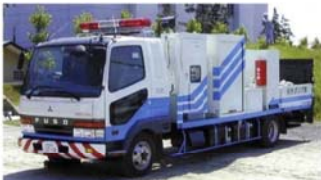
排水ポンプ車(排水能力毎分30m 3 の水車モータ式)
