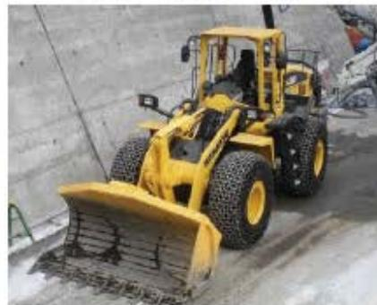
狭いトンネルで使用するためバケットが横向きにダンプする特殊な構造のホイールローダです。発破後のすりをダンプトラックやベルトコンベアに載せます。
