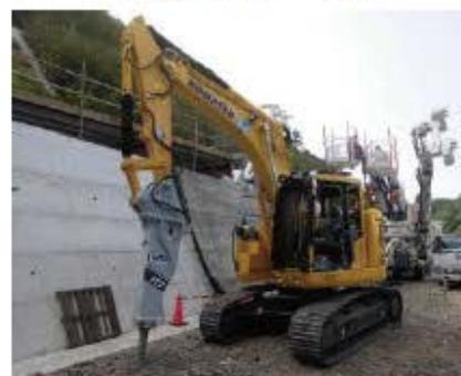
先端のヘッドで打撃を与えて岩盤を破碎します。発破後の地山の仕上げ掘削に使用します。
