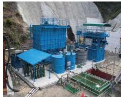
工事で使用した汚れた水をきれいにする設備です。きれいにした水は取水河川に放流したり、工事で再度使用します。
