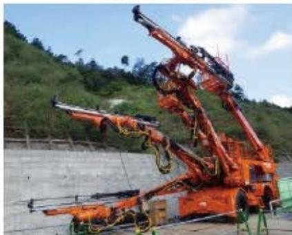
削岩機を搭載した3本の腕と、搭乗ケージ2本を装備したドリル工事の主要機械です。岩盤に発破の装薬やロックホルトを挿入する穴を削孔します。
