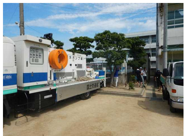
プールに流れを作るポンプを動かすため、 プール脇に排水ポンプ車を駐車します。
