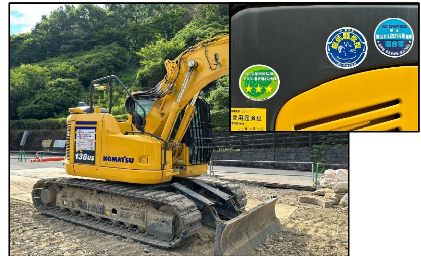
排出ガス対策型・低騒音型建設機械
