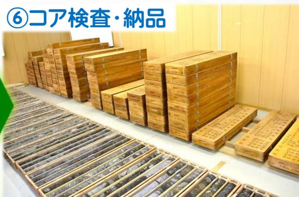
一連の作業が完了した段階で所定のコア倉庫に納品します。その後、地質解析をする他業者がコアを観察し、ダムを建設する上で必要となる多くの基礎資料に使用されます。
