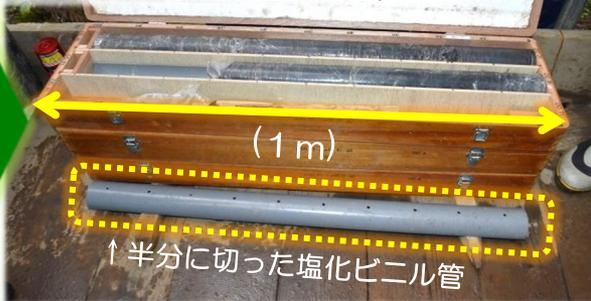
運搬時の衝撃を防ぐため、かまぼこ型のように半分に切った塩化ビニル管をコアの上下にかぶせ、フタの内側に発砲スチロール材を敷いた**コア箱**という木箱へ曲がらないように格納し、水平を保ったまま細心の注意を払い作業所へ運搬します。
