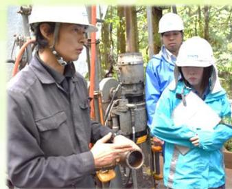
ボーリングマシンは小型で軽量のものでも**200kg以上** 中型・大型以上のものは**500kg~1000kg(1t)以上**も重量があります
