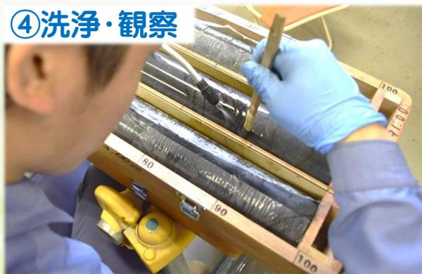
掘削時に表面に付いた汚れだけを、噴霧器の水で指やハケを使いコアを傷めないよう細心の注意を払って丁寧に洗浄します。洗浄後は、撮影・観察、柱状図の作成をします。
