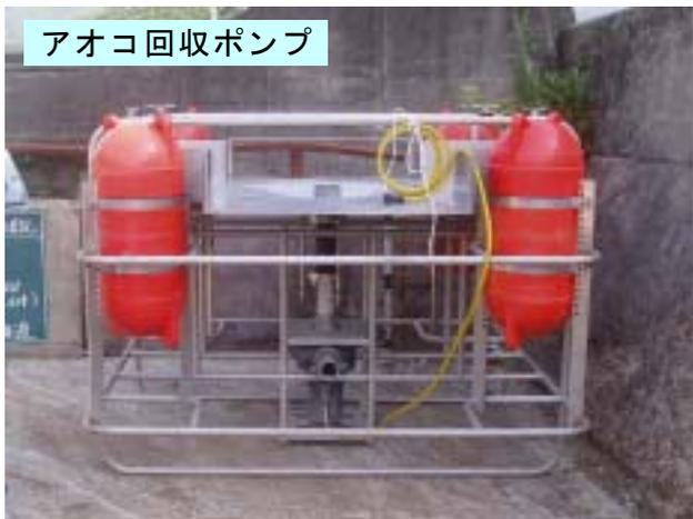
水面付近のアオコを効率良く汲み上げる為に表面取水型の形状としている。
