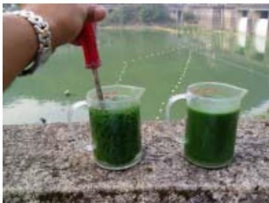
左側ビーカーの原水に凝集沈降剤を投入・攪拌する。
