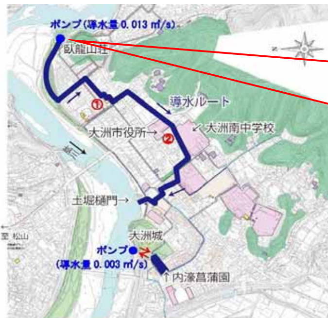
大洲城内濠浄化の主な整備箇所
