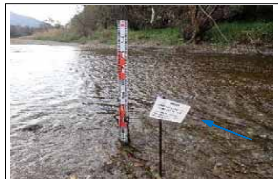
水位計設置状況（撤去前）
