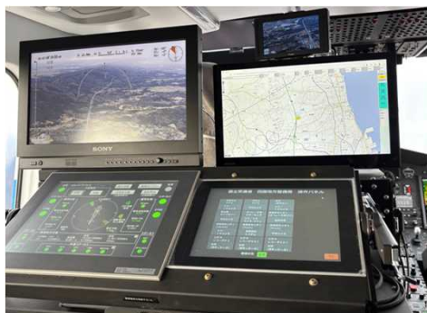
【ヘリコプター搭載型衛星通信設備(ヘリサットシステム)】
