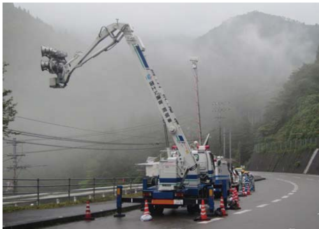
監視活動を行う衛星通信車のカメラと 夜間監視のための照明車
