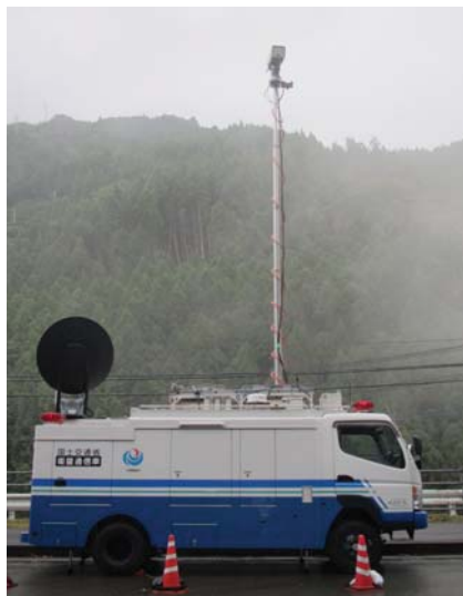
監視活動を行う衛星通信車のカメラと 夜間監視のための照明車
