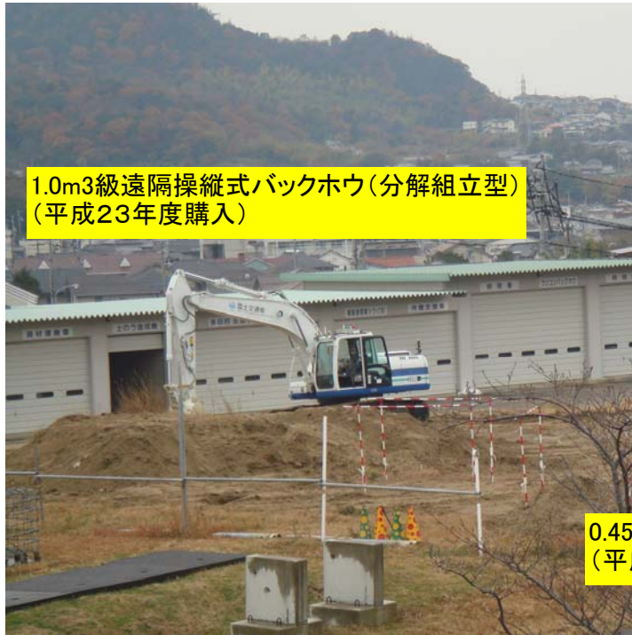
約20m離れた場所から 目視による遠隔操縦訓練
