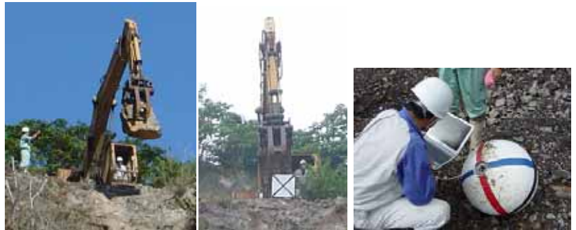
写真 2.3 フォークによる投石と加速度計測状況
