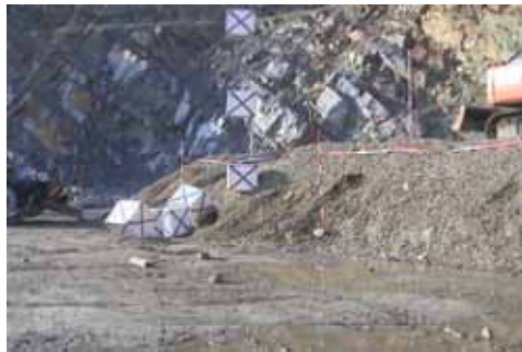
立方体を盛土斜面に落下させたときのバウンド
