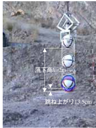
平坦な岩盤に落下させたときの球の跳ね上がり
