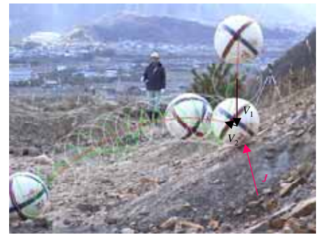
球を岩盤斜面に落下させたときのバウンド
