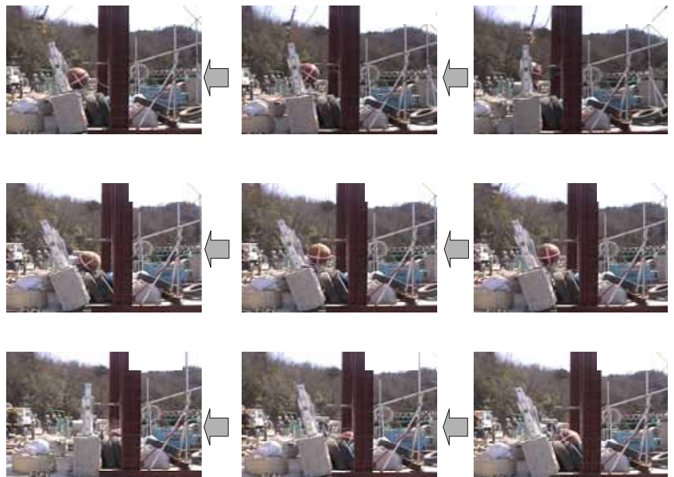
写真-1 基礎の応答(case-1 落下高2.5m)
