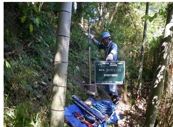
地質観測(孔内傾斜計等)
