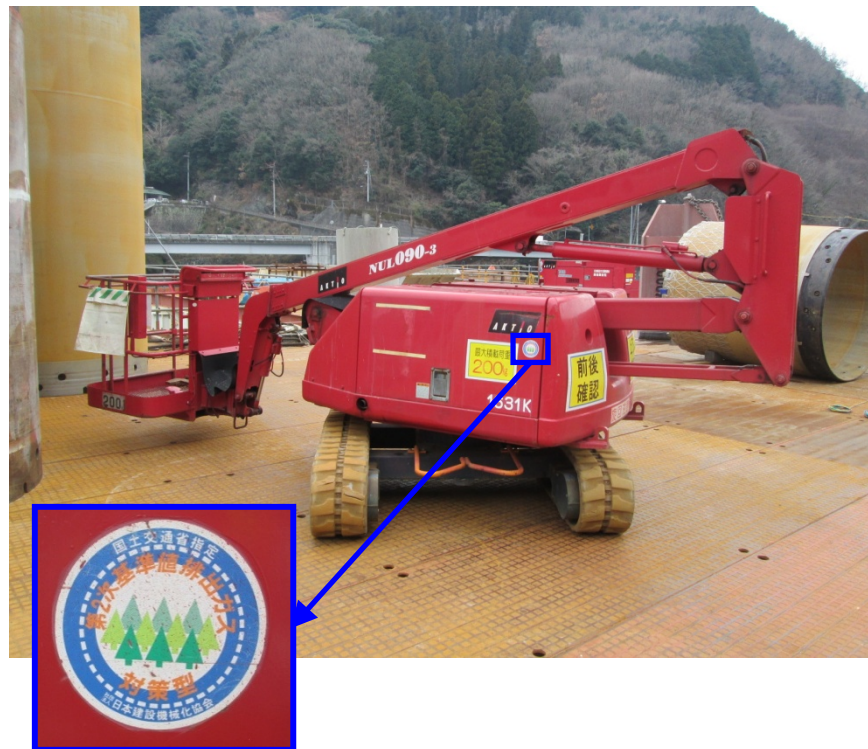
(c)排出ガス対策型建設機械の使用
