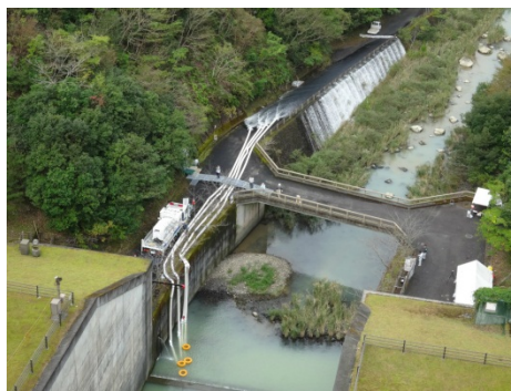
国土交通省の排水ポンプ車実演。水をくみ上げて、離れた場所に流す仕組みを紹介
