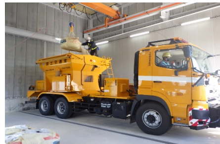
凍結防止剤の積み込み訓練
