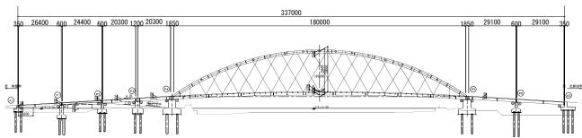
●鏡川大橋は、1981年(昭和56年)3月に完成した橋長337.0m、幅員33.3mの7径間の橋梁であり、鏡川に架かる橋梁では、径間が1番長い橋(アーチ部分がニールセン橋※L=180.0m)となっています。 鏡川大橋は、平成16年4月に高知市より国土交通省へ移管された橋梁であります。
