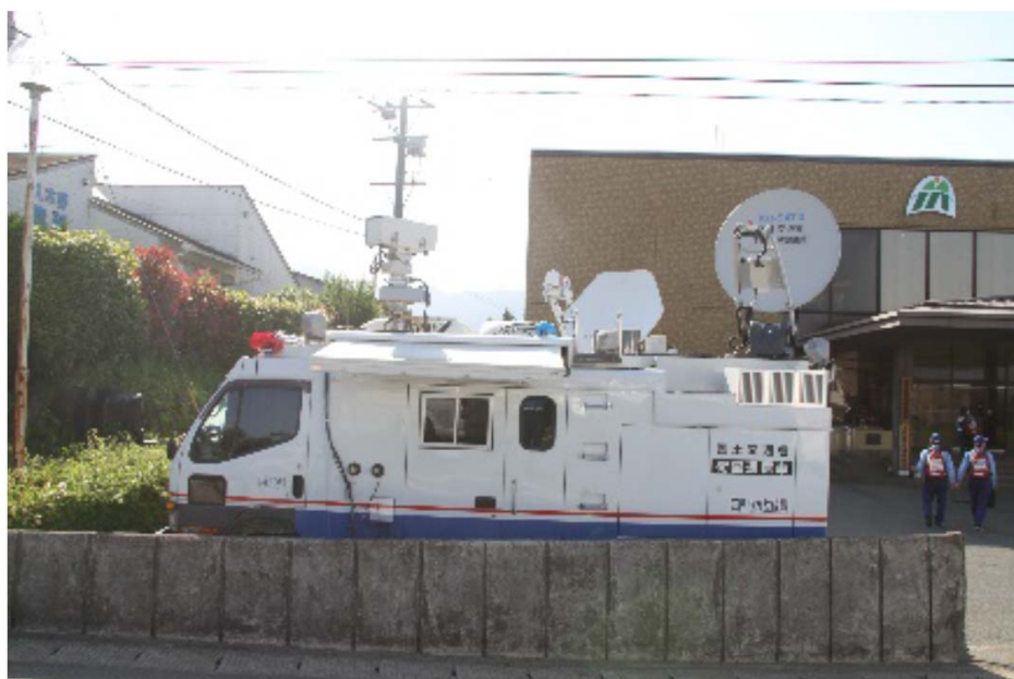
平成28年熊本地震での緊急災害対策派遣隊(TEC-FORCE)活動状況 (熊本県阿蘇郡南阿蘇村久木野庁舎) 衛星通信車による通信確保等の復旧作業支援状況
