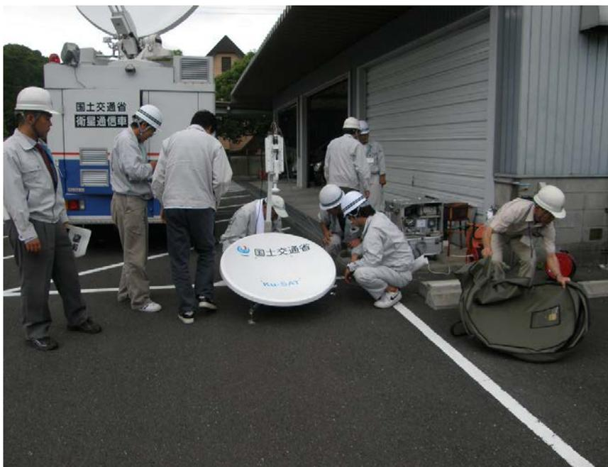
衛星通信車、可搬型衛星通信装置(Ku-SAT II)
