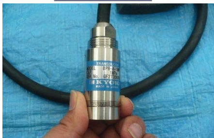
ボーリング孔内に設置、液状化層の間隙水圧を測る
