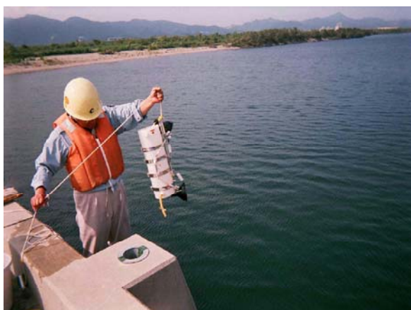
定期水質観測（採水状況）
