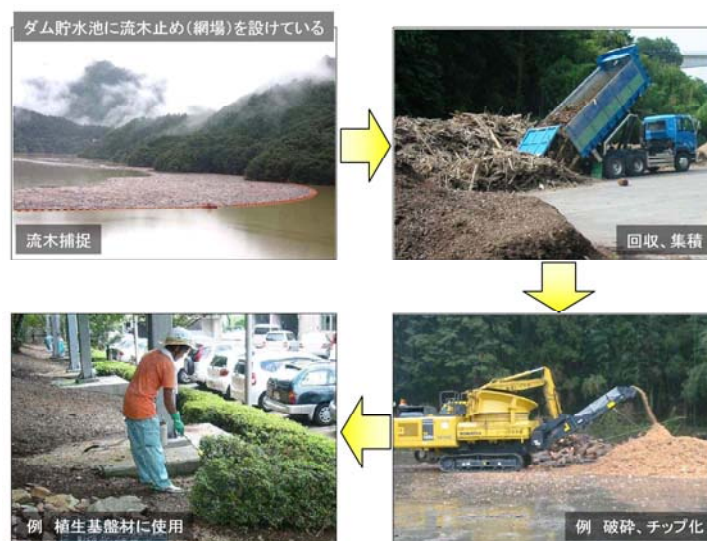
図－4.2.1 ダムによる流木の捕捉、回収、有効利用の例
