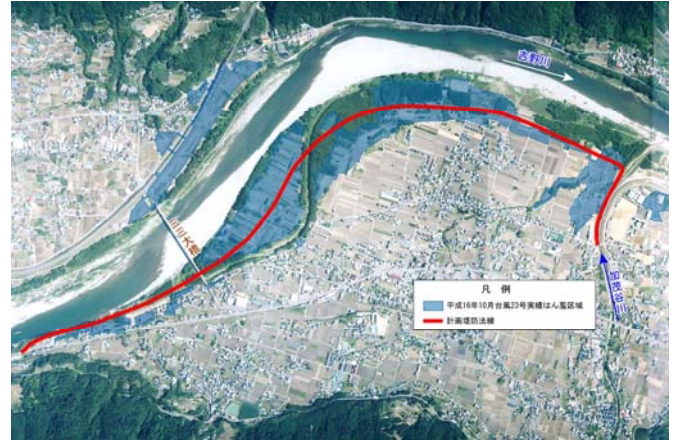
平成16年10月台風23号実績はん濫区域
