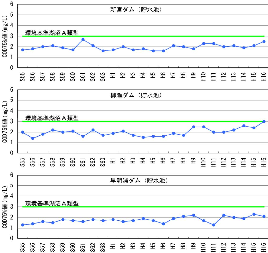
図 - 2.2.10 ダム湖定期水質観測地点（表層）の水質経年変化(COD75%値：mg/L)
