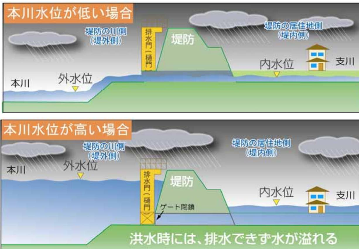
内水：本川（吉野川）水位が高く、堤防の居住地側（堤内側）に多くの雨が降った場合に雨水が本川（吉野川）に排水できず、支川（水路）から水があふれ住宅地等が浸水する現象。
