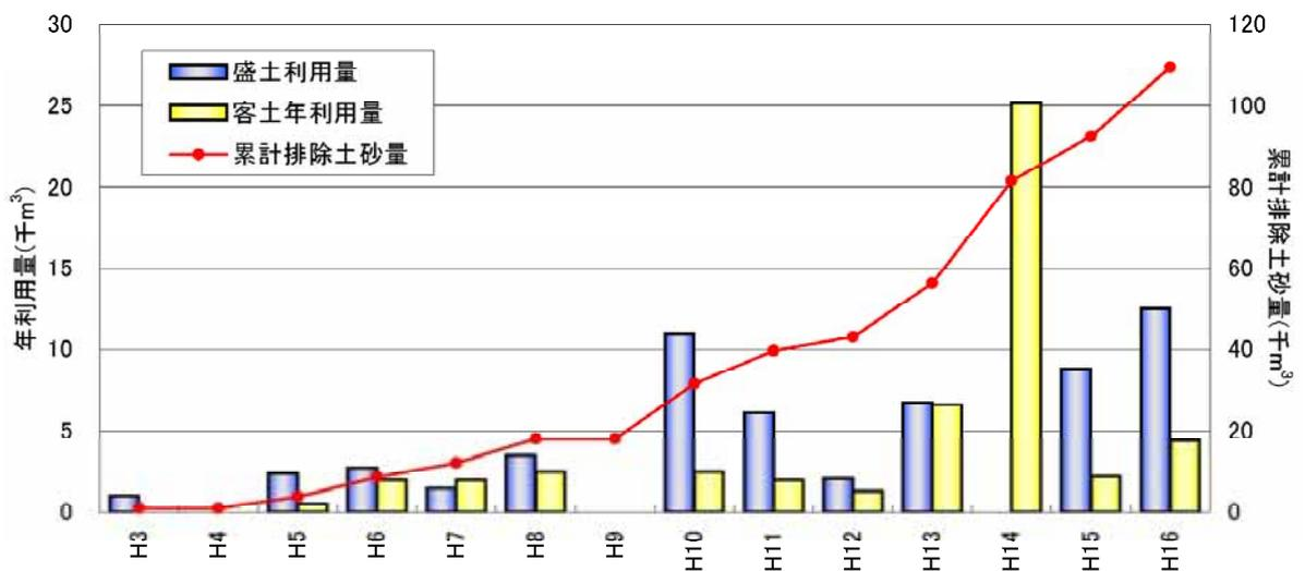
図 - 2.1.24 柳瀬ダム堆積土砂の客土への利用状況図
