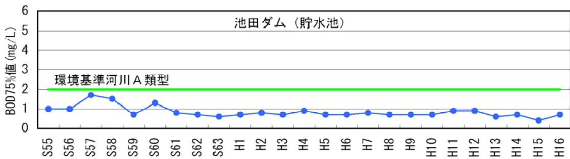
図 - 2.2.11 ダム湖定期水質観測地点（表層）の水質経年変化(BOD75%値：mg/L)
