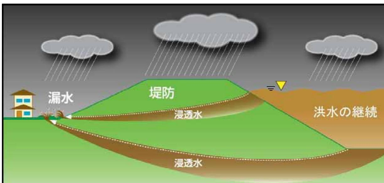
漏水：洪水時に生じる現象で、河川水の堤防への浸透によるものと、基礎地盤の浸透による場合がある。河川水位が高く、その水位の継続時間が長いほど堤防に水が浸透し漏水現象が発生しやすくなり、堤防が壊れやすくなる現象。
