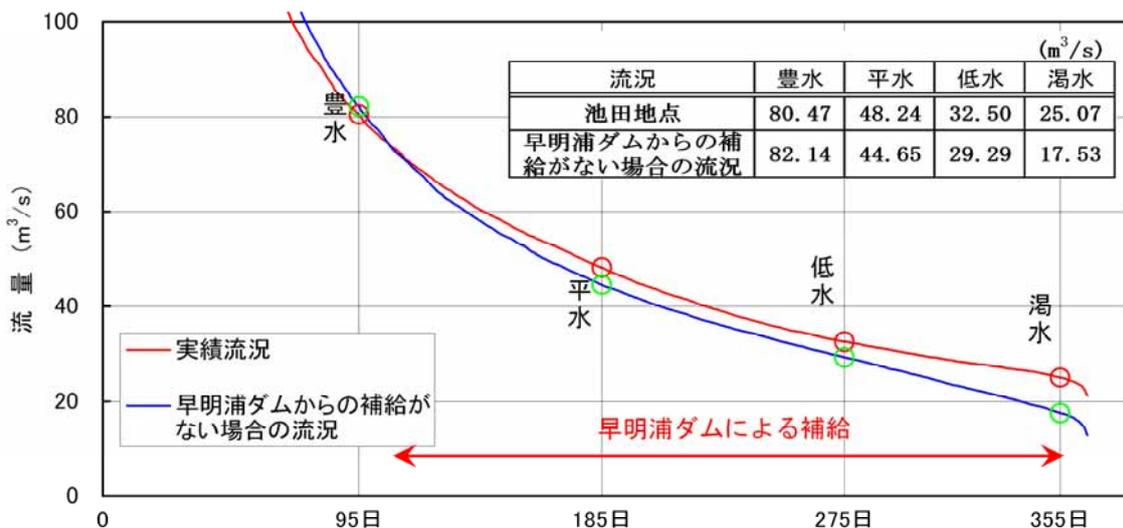
図 - 2.2.4 早明浦ダムによる流況の安定化（池田ダム流入地点）
