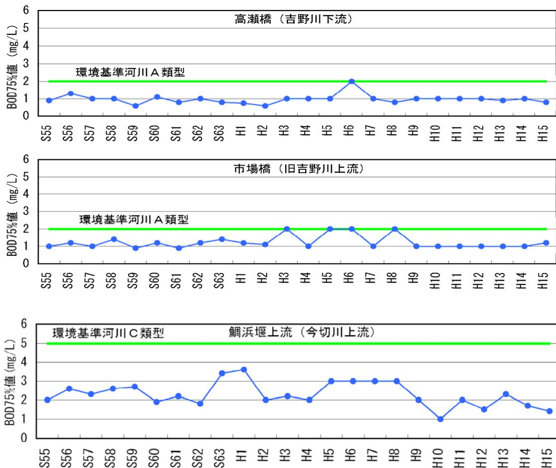
図 - 2.2.9 吉野川水系定期水質観測地点の水質経年変化 (BOD75%値 : mg/L)
