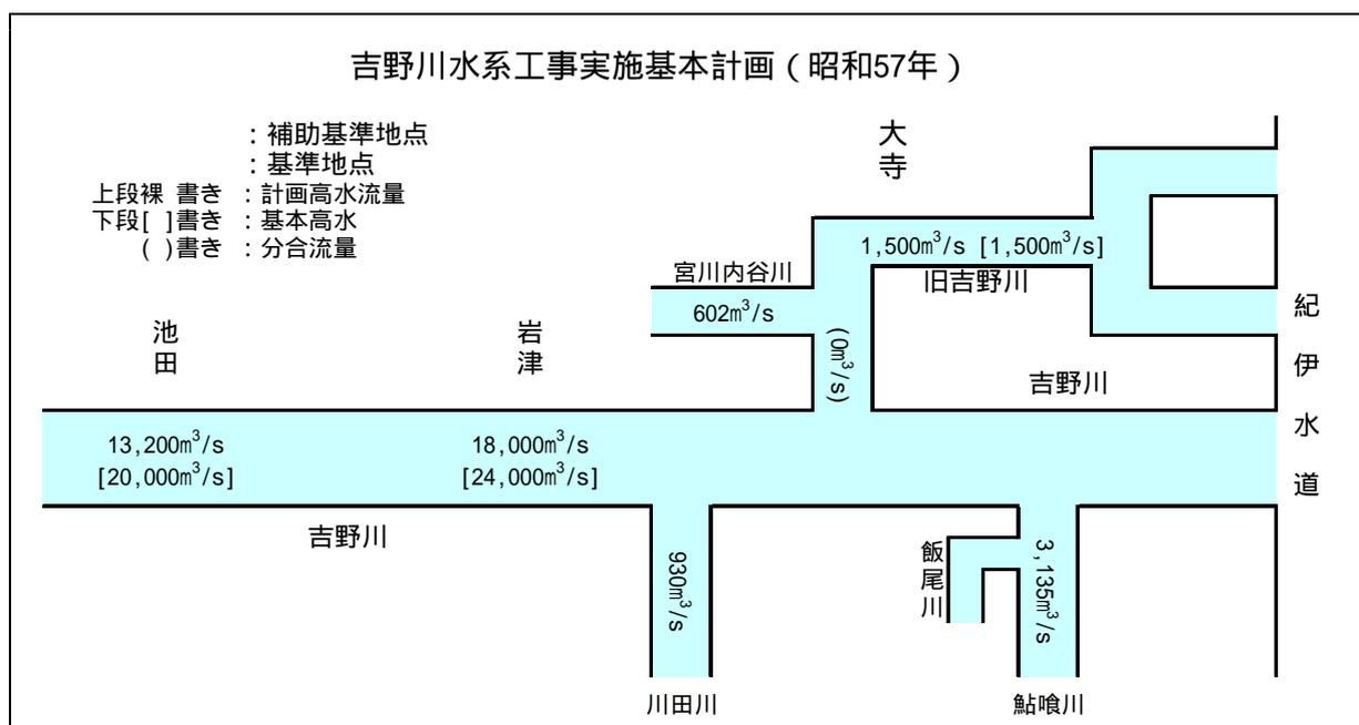
図 - 2.1.7 吉野川水系工事実施基本計画の計画高水流量図(昭和57年)
