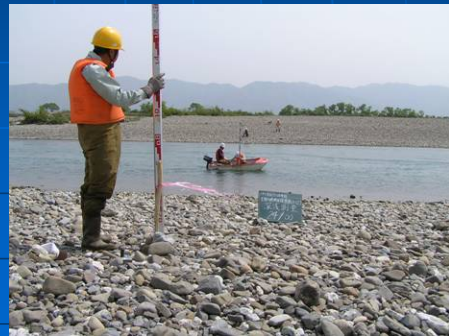
河床変動調査状況(河川横断測量)
